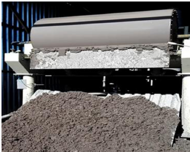
รูปที่ 7-1 กากตะกอนจากระบบรีดตะกอนชนิด rotary vacuum drum filter
