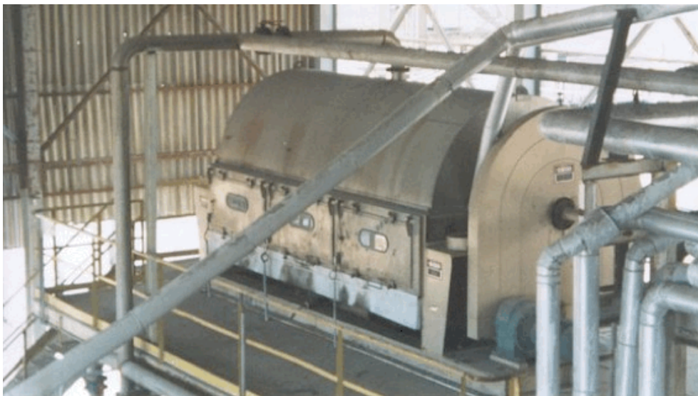
รูปที่ 1-5 เครื่องผลิตโซดาไฟชนิดแข็ง (caustic flaker)
