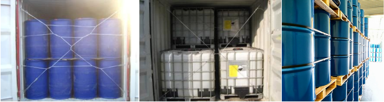
รูปที่ 4-2 ตัวอย่างวิธีป้องกันการเคลื่อนตัวของบรรจุภัณฑ์สารเคมีเพื่อการขนส่ง
